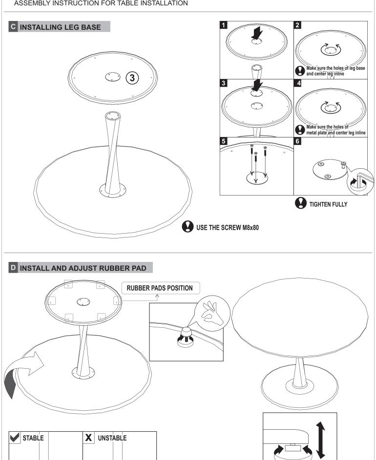
THIS IS A COMPULSORY ACTION TO MAKE SURE ALL OF THE RUBBER PADS TOUCH THE GROUND!
