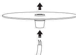
3) Raccordez le câble au câble électrique du plafond.
