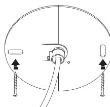
6) Après raccord des composants électriques, mettre en place le cache-câble en le collant au plafond.
